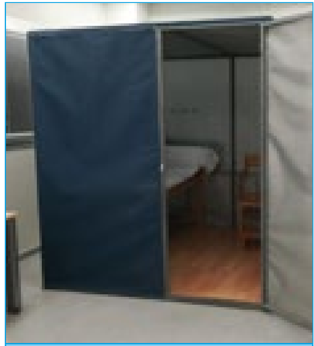
Figura 20. Jaula de Faraday donde se realiza el tratamiento para evitar interferencias externas.
